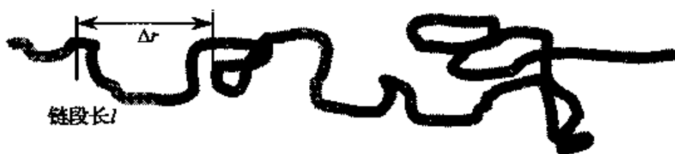
图 13.1.5 考察长度 l 的链段的平均形变的示意图
